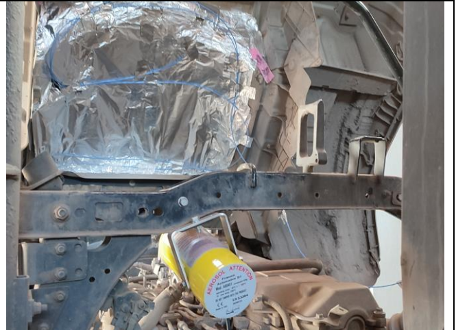
Supresor y cable termosensor 1° posición
