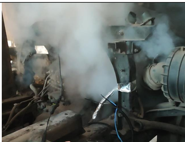
Evidencia efectividad de sofocación del fuego.
